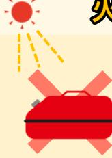
直射日光等によりガソリンの温度が上昇すると、貯蔵容器内の内圧も上昇します。その状態で容器のふたを開けると大量の可燃性蒸気が放出されます。ガソリンを貯蔵する場所は、直射日光の当たらない風通しの良い場所で、コンロ、お客様から離れた位置としてください。
